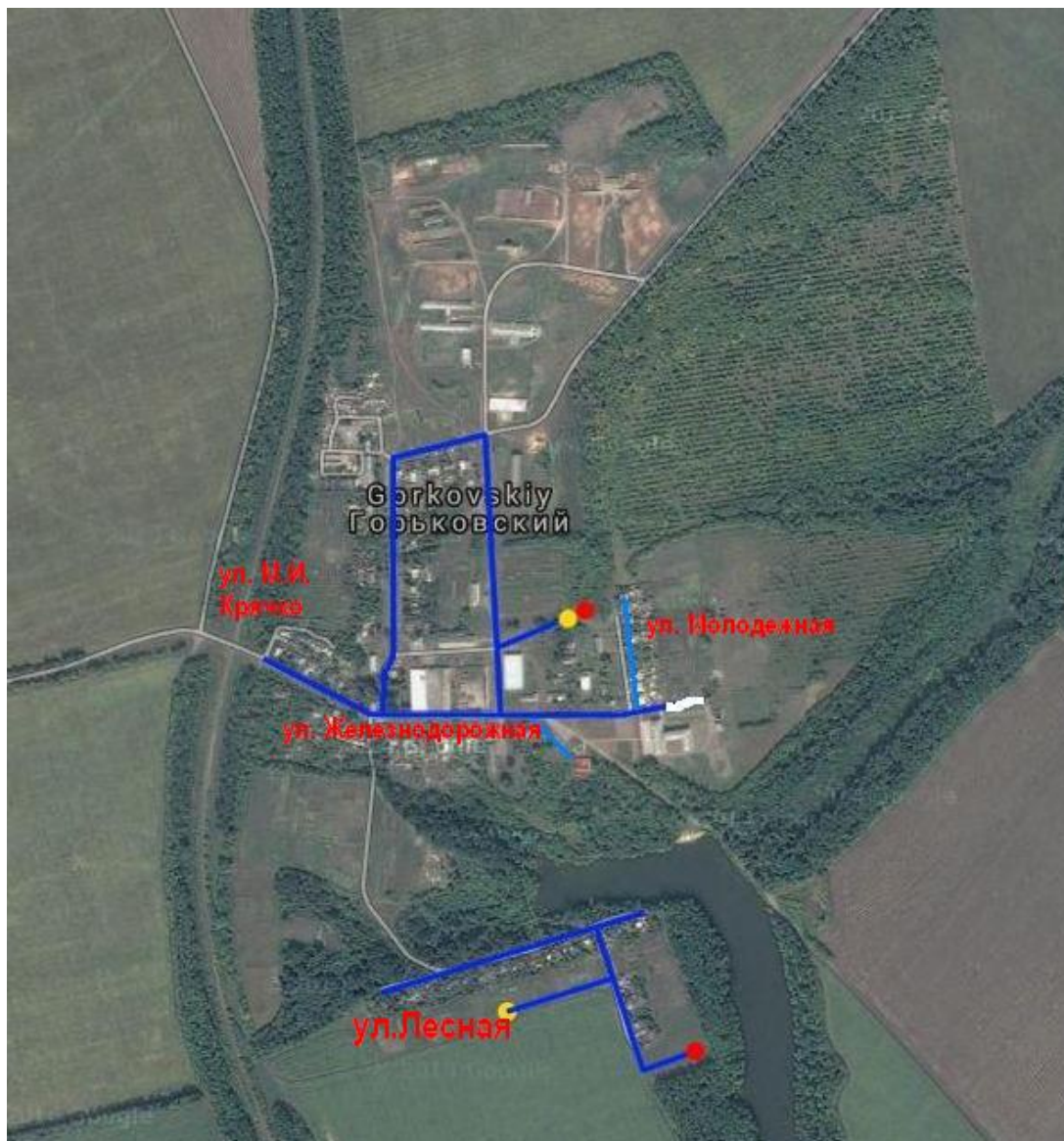
Рисунок 6. Схема водоснабжения п. Горьковский.
