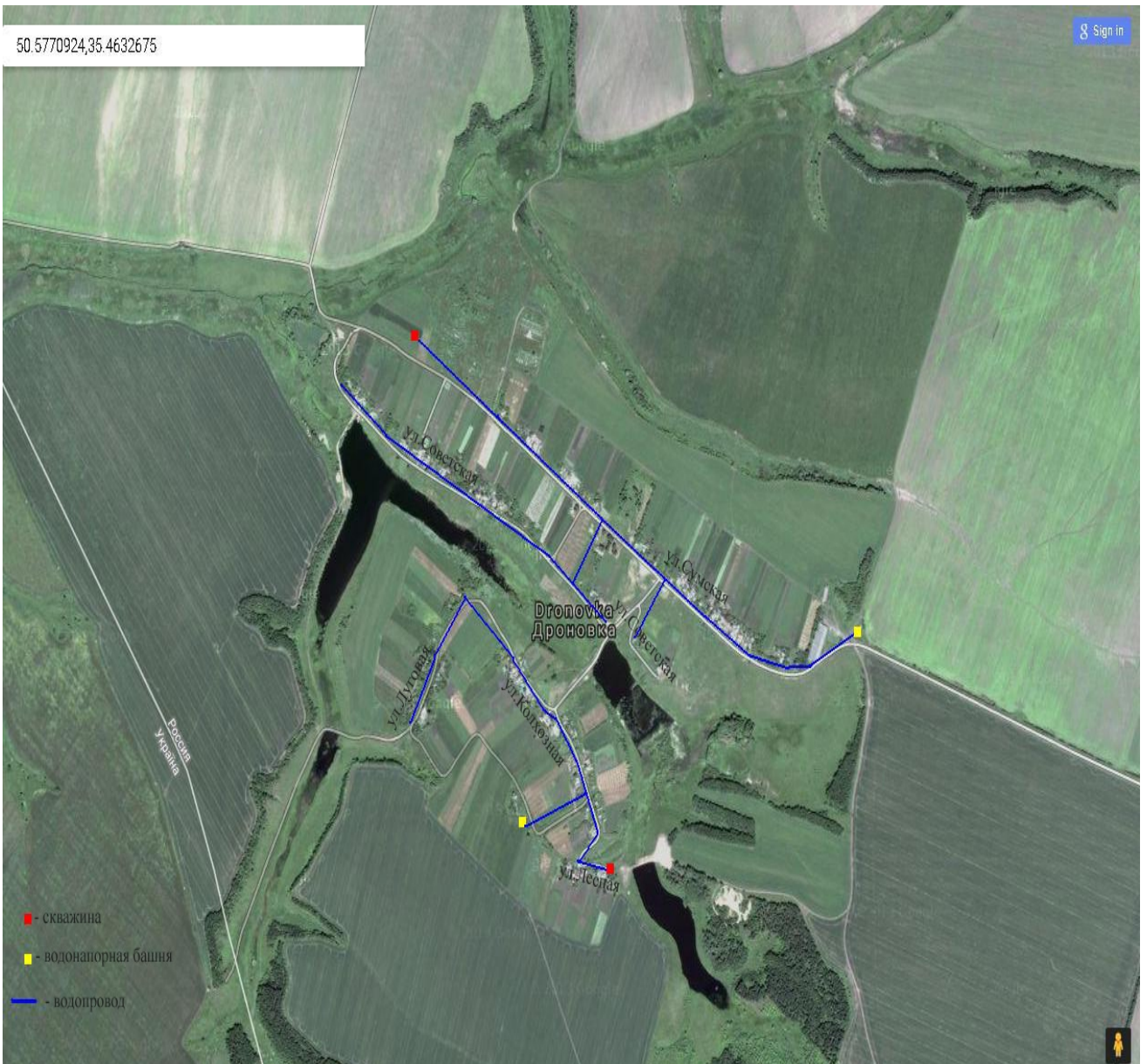
Рисунок 19. Схема водоснабжения с. Дроновка.
